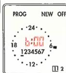
*Indication : Le réglage s'effectue minute par minute. Une pression sur la touche = 1 minute. Si l'on maintient la touche appuyée, le réglage se fait plus rapidement.*
