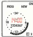
On peut régler au maximum 4 horaires de mise en circuit et de mise hors circuit par jour et par sortie.
